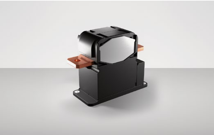
Kompakte 1-polige Schließerschütze für DC bis 1.500 Volt Bemessungsisolationsspannung. Einschaltstrom bis 6.000 Ampere, Dauerströme bis 500 Ampere, Kurzzeitstrom bis 6.000 Ampere.
