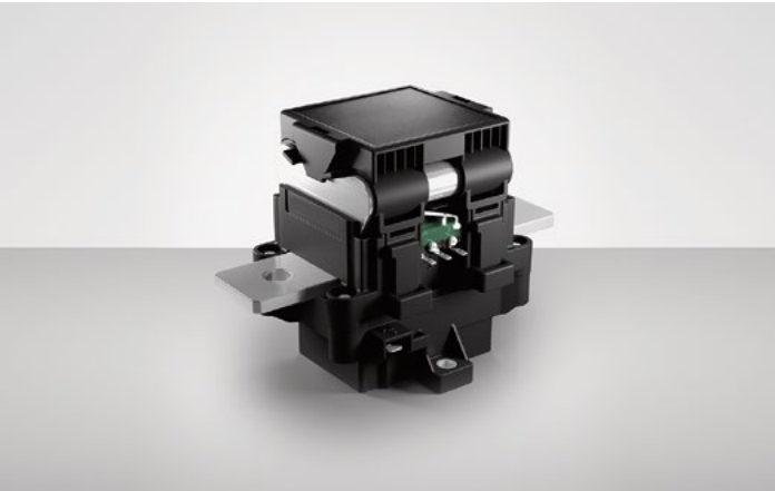
Kompakte einpolige Schließerschütze für DC oder AC bis 1.500 Volt Bemessungsisolationsspannung. Einschaltstrom bis 2.500 Ampere, Dauerströme bis 150, 300 oder 500 Ampere, Kurzzeitstrom bis 3.000 Ampere.
